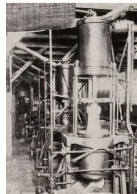
5) 機械式手巻き用線香押し機 製作年：1910年頃(明治末期)～1957(昭和 32)年頃まで使用 [左]現在は横倒しで保存中 [右]昔の実際の使用写真
