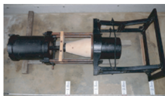
図6 機械式手巻き用線香押し機(製作：1910年頃～1957年頃まで使用。(左)現在は横倒しで保存中、(右)昔の実際の使用写真)
